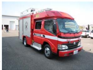
↑中消防署に配置された泡圧縮吐出装置積載車
