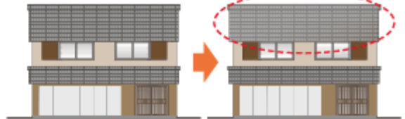
修繕（老朽瓦の葺き替えなど）
