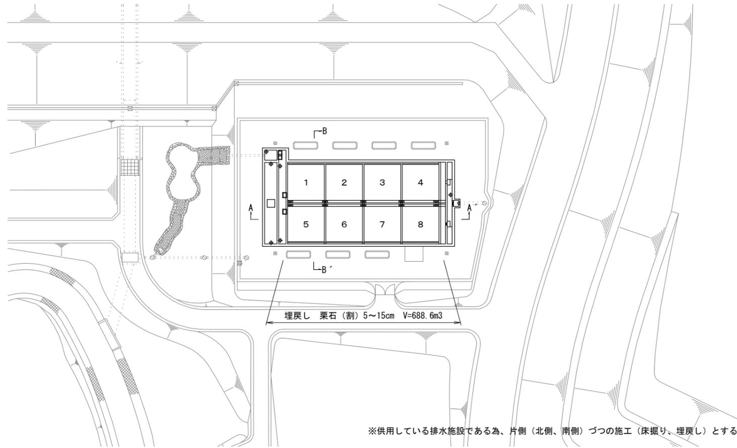
※供用している排水施設である為、片側（北側、南側）づつの施工（床掘り、埋戻し）とする。
