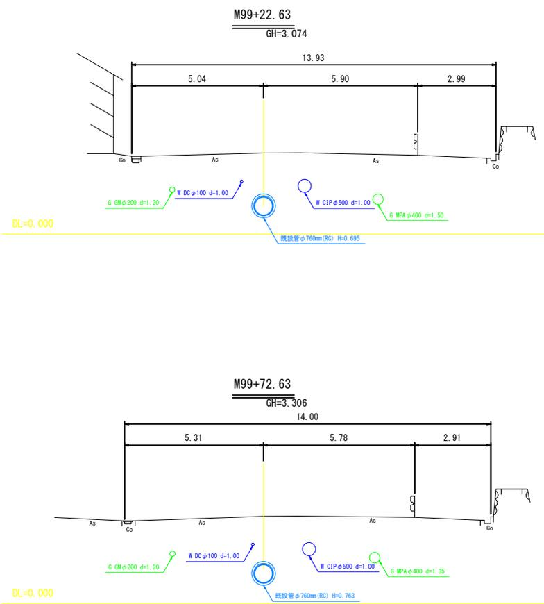
※管底高は既設管管底高を示す。
