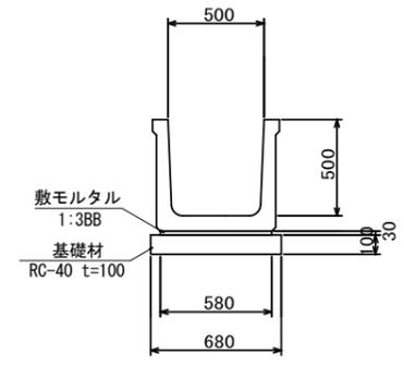
鉄筋コンクリートU型 (B500-H500) 10.0m当り
