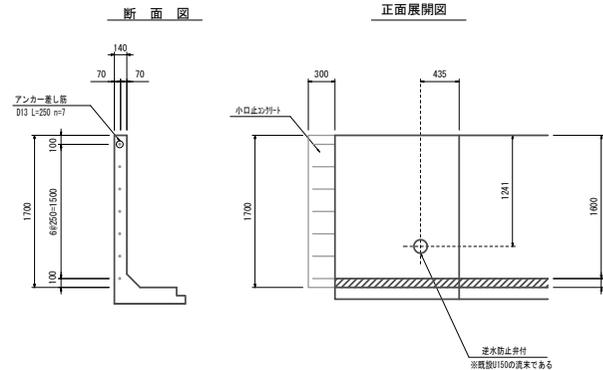
水路用鉄筋コンクリート型ブロック
