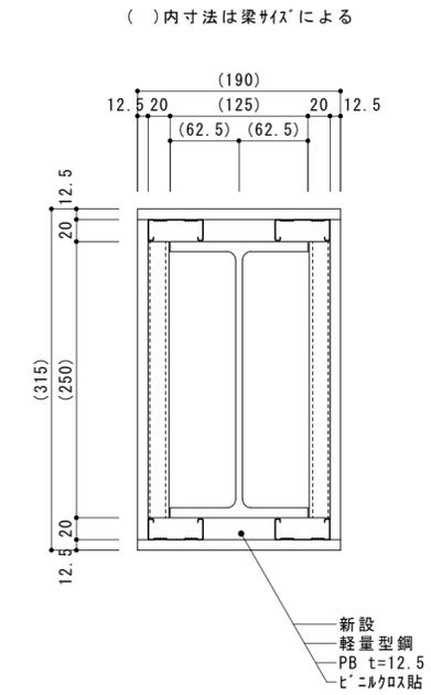
防火壁(1時間耐火)標準詳細図 s=1/5
