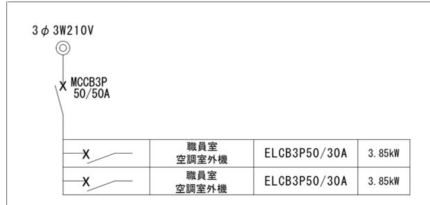
電灯分電盤 L-1-1(特別教室管理棟) 鋼板製 露出型
