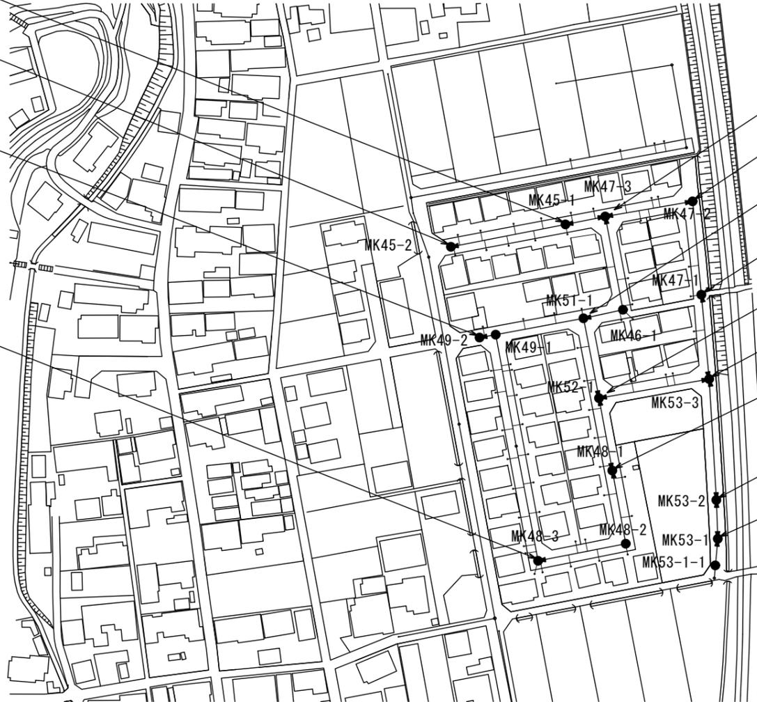
本管ロVカット補修工(本管径φ200mm) N=3箇所(ランクB、C 上下流)
