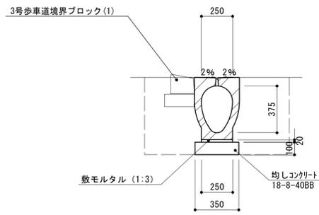
管渠型側溝(フラットタイプ) 単位数量表 10m当り
