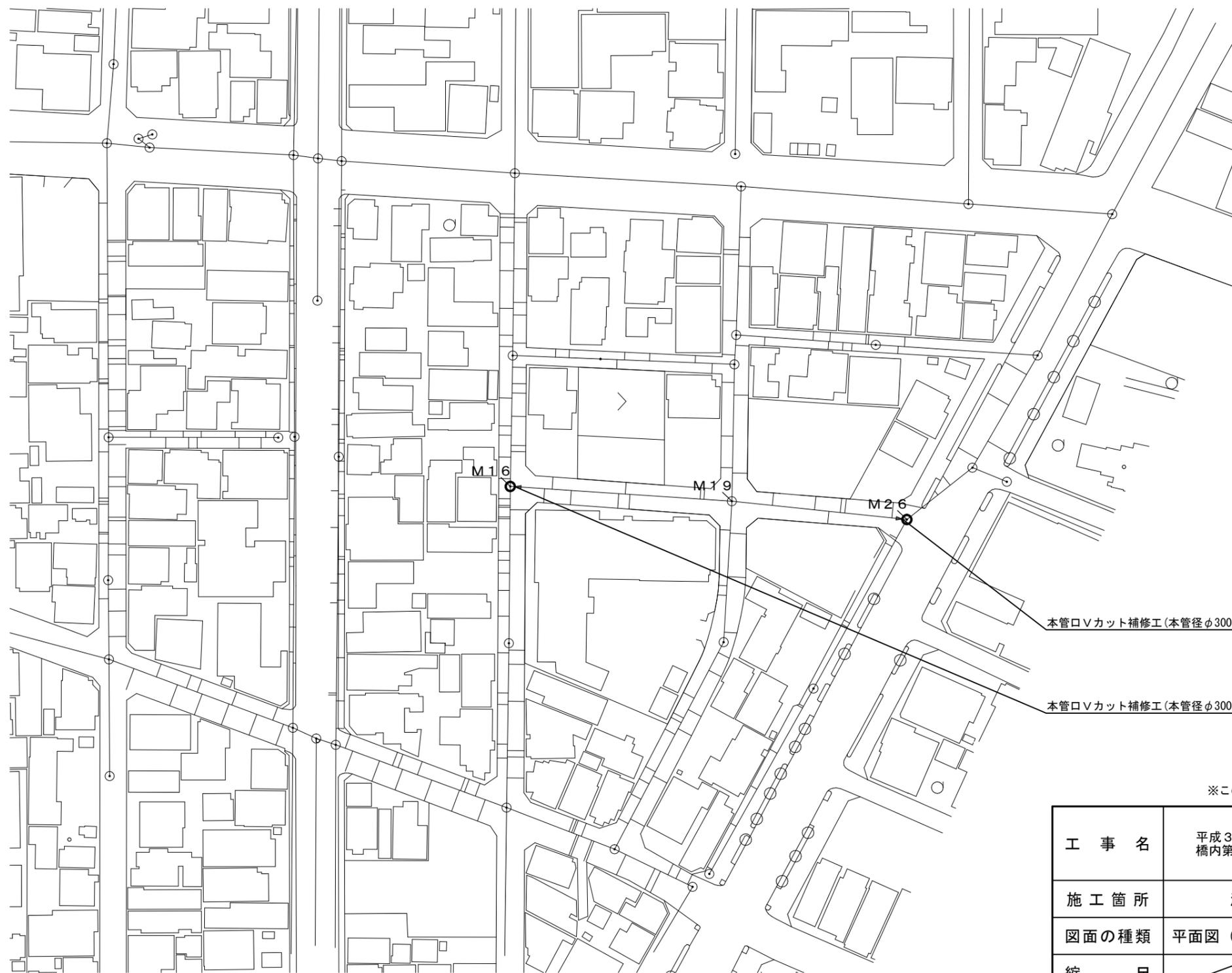
本管口Vカット補修工(本管径φ300mm) N=1箇所(ランクA 上流)
