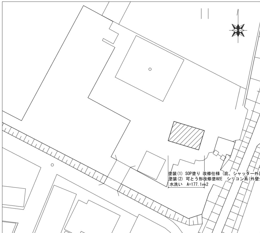
塗装(1) SOP塗り 改修仕様 (庇、シャッター外面) A=37.4m<sup>2</sup>
