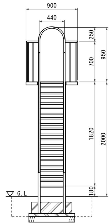
材料表 滑台(一方向滑台 H=2.0m)
