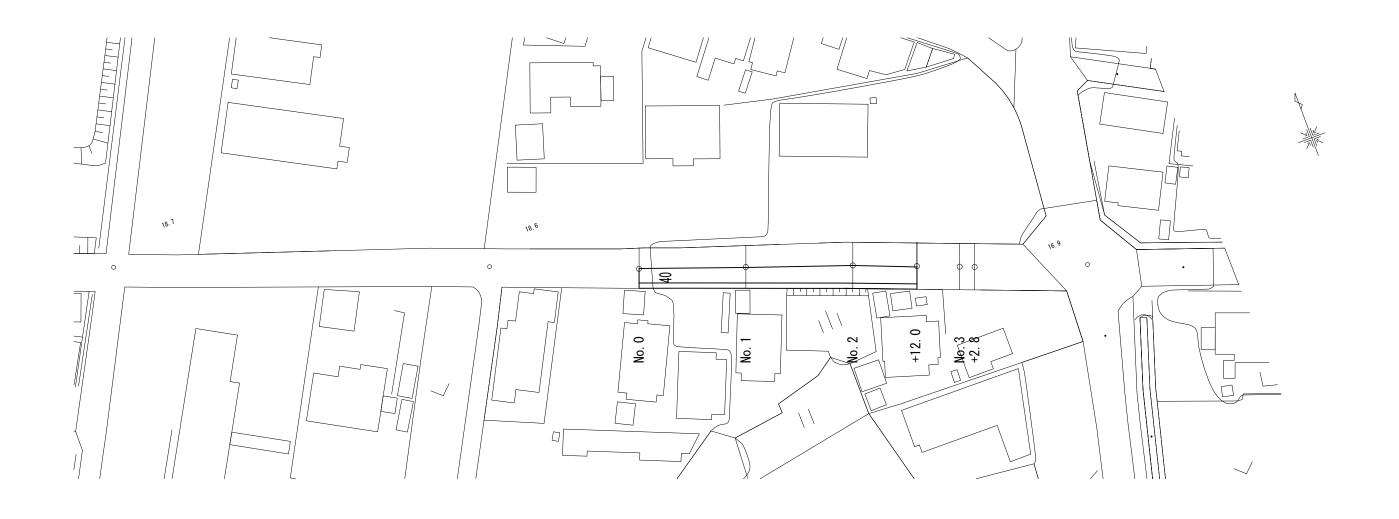
表層 A=209.0m2 基層 A=209.0m2 上層路盤 A=209.0m2 下層路盤 A=209.0m2 安定処理 A=146.6m2
