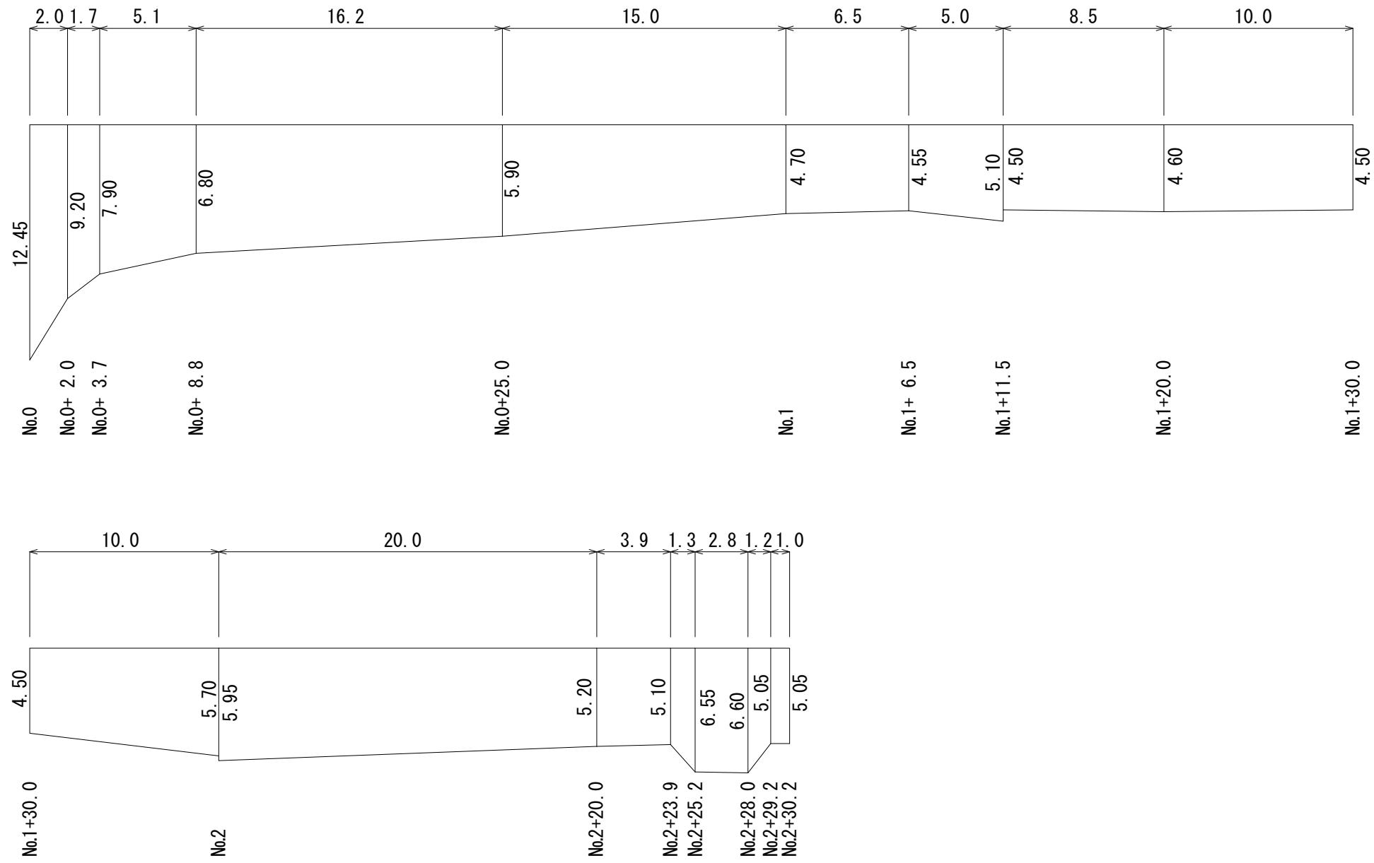
舗装版破碎・不陸整正・表層展開図(B路線)
