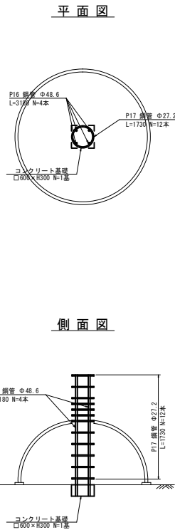
複合遊具撤去詳細図⑥ S=1/50
