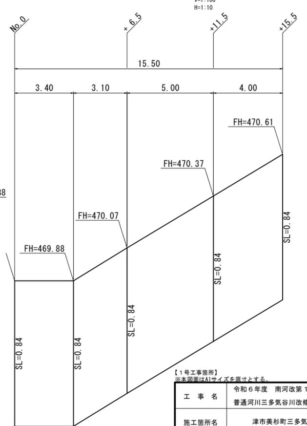
コンクリート根継構造図
