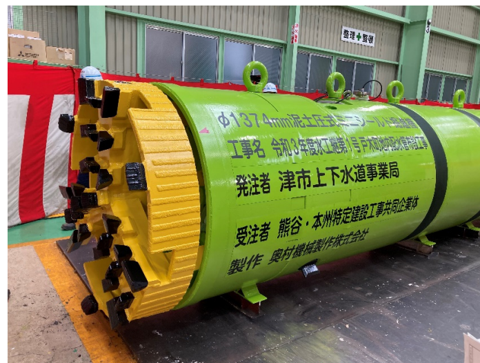
図 5.6 基幹管路耐震化事業（ミニシールド掘進機）
