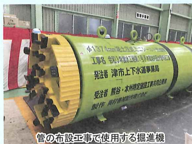
管の布設工事で使用する掘進機
