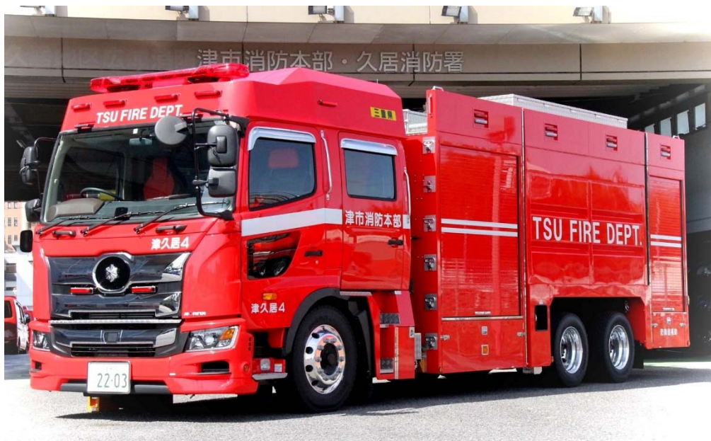
大型水槽付消防ポンプ自動車
