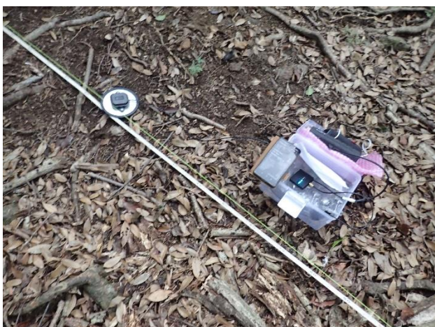
GPSを活用した測量基準点の設定
