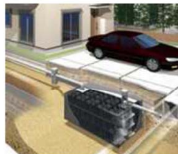
貯留浸透ます・貯留槽
