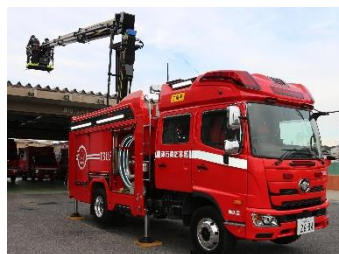
久居消防署へ導入した 伸縮ブーム付多目的消防ポンプ自動車
