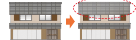
修繕（老朽瓦の葺き替えなど）
