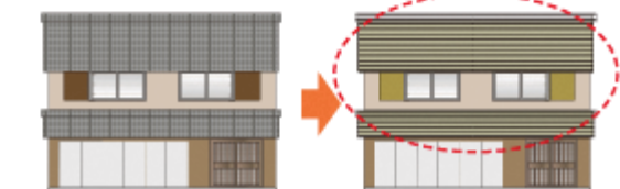
模様替（屋根瓦別素材で葺き替え）
