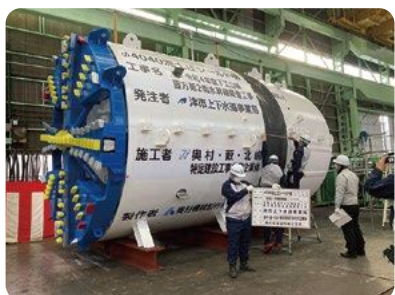
管径3.4mの雨水管を築造したシールドマシン
