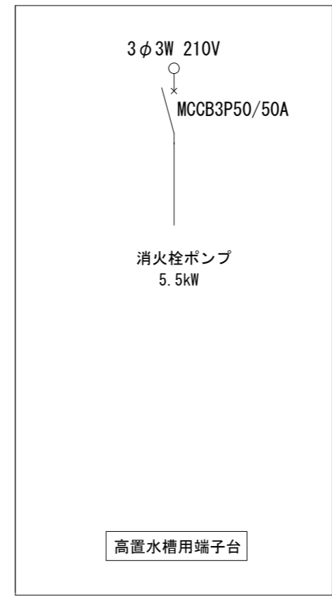
動力盤 (P-2) 自立型 改修後
