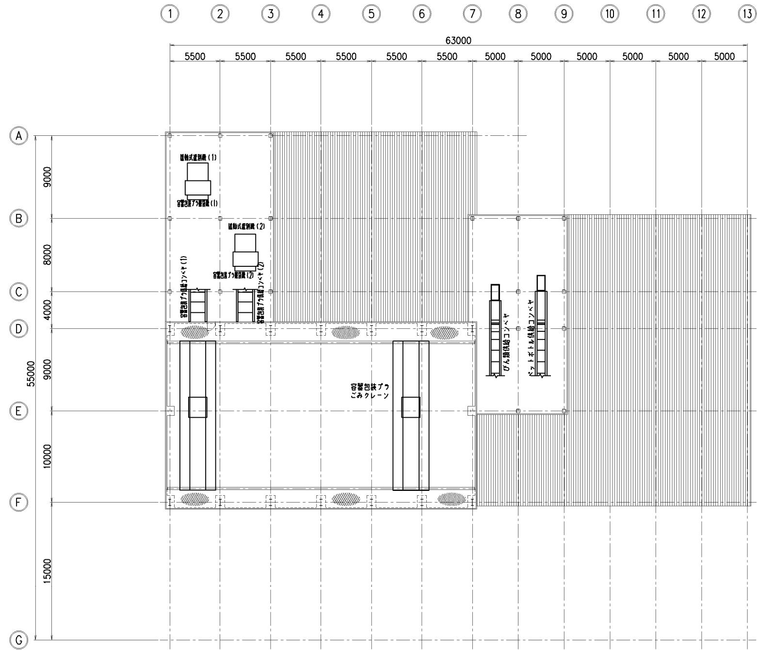
リサイクルセンター 4FL(1FL+14000)付近 平面図 S=1:400
