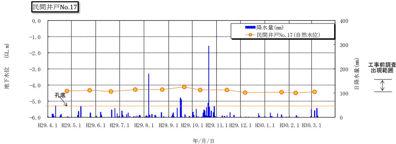
図 4. 2. 2-4 民間井戸水位（携帯型触針水位計）調査結果
