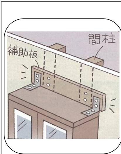
L字金具と皿木ネジで壁裏の間柱や胴縁に家具等を直接固定することができないときは、補助板等を間柱や胴縁に固定する。
