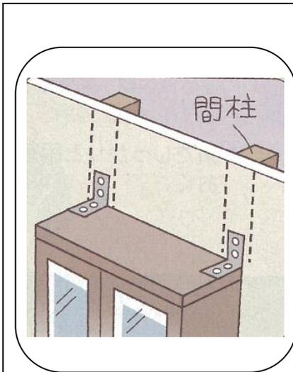
L字金具と皿木ネジで壁裏の間柱や胴縁に家具等を固定するときは、家具等をできるだけ壁面につけて置き、間柱や胴縁の中央付近に固定する。
