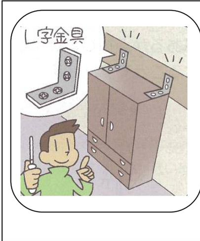
L字金具と皿木ネジで家具等を固定するときは、家具等をできるだけ壁面につけて置き、横柱や鴨居など構造的に強い部分に直接固定する。
