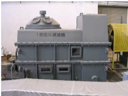
桜橋ポンプ場 1 号雨水ポンプ用減速機
