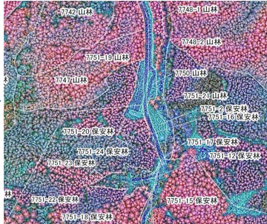
航空レーザ測量で得られる、判断の際に特徴となる複数のデータ（反射強度など）を彩色することで、航空写真で判断しにくい影部や航空写真には表れない色調によって細かな違いを表現
