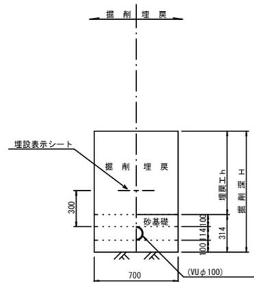
既設管撤去定規図 S=1:20
