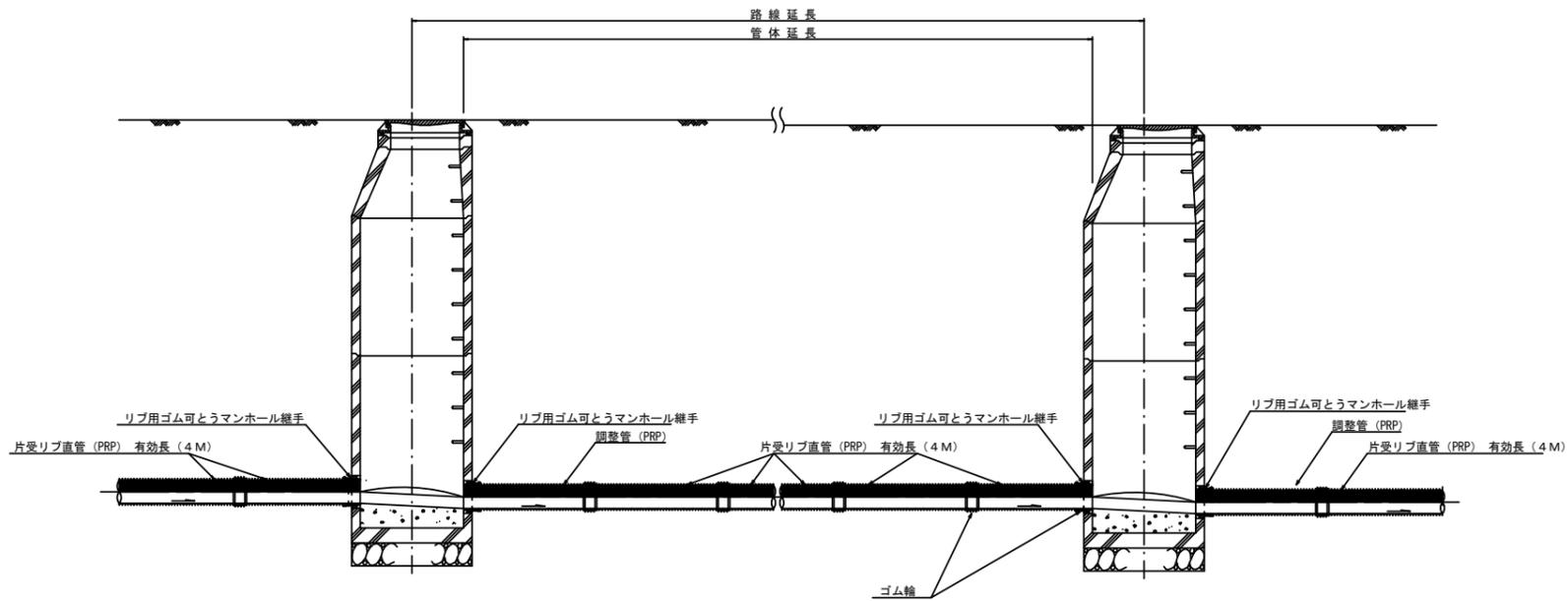
注) 調整管が1.0m未満の場合は、1.0mで切断をし片受直管で長さを調整する。
