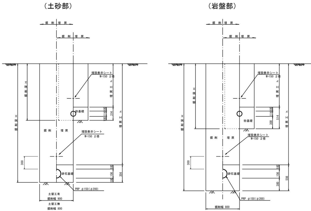
取付管土工定規図 S=1:20
