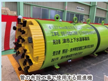
管の布設工事で使用する掘進機
