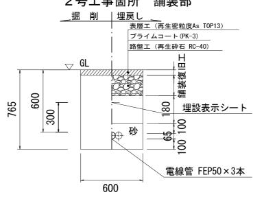
電線管土工断面図
