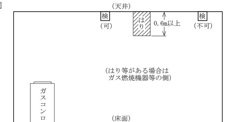
(ウ) 天井面等の付近に吸気口がある場合は、燃焼器又は貫通部から最も近い吸気口付近に設けること。(第12-3図)
