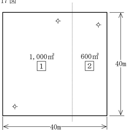
(注) 1,000m<sup>2</sup>と600m<sup>2</sup>に分割する。なお、警戒区域一覧図が容易に識別できるように境界線は直線状にもうける。
