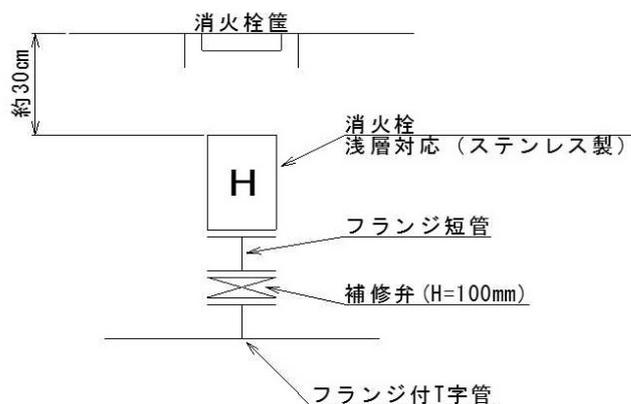
※フランジ短管で消火栓の高さを調整する。
