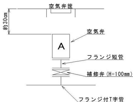
※フランジ短管で空気弁の高さを調整する。
