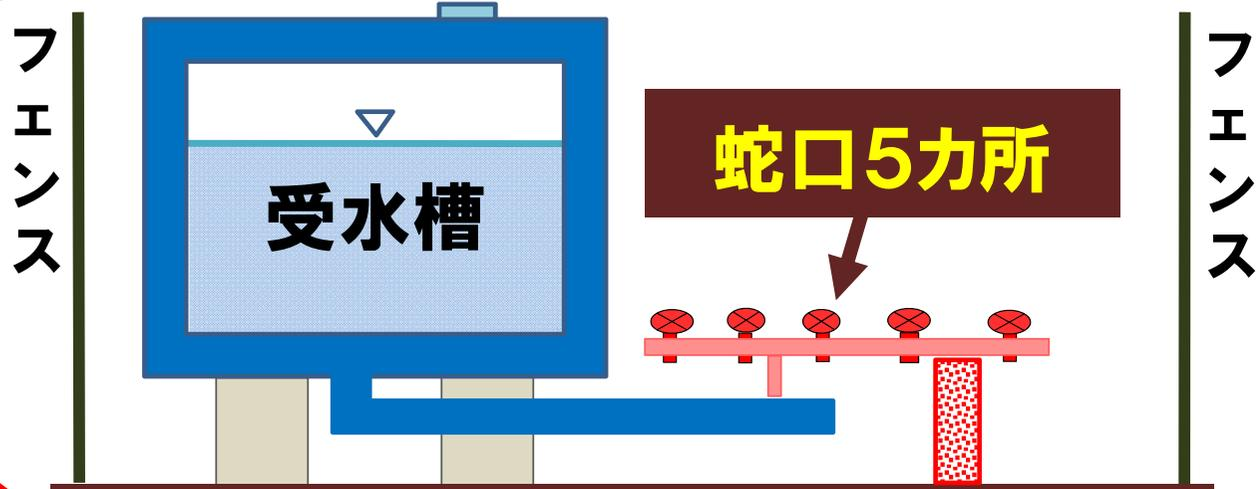
※受水槽方式: 高さのある公共施設やビルなどは、建物内の水道に送る水圧が確保できないため、配水管から送られてきた水道水をいったん受水槽に貯水した後、ポンプでさらに高架水槽へくみ上げる受水槽方式がとられます。
