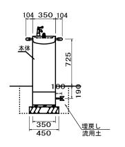
本体: 擬石 研ぎ仕上 手摺: ゆ38×t2.0ステンレス鋼管 水栓: 水飲み(レバー式) 上部手洗い(レバー式) 下部管理用(回転式) 質量: 360kg
