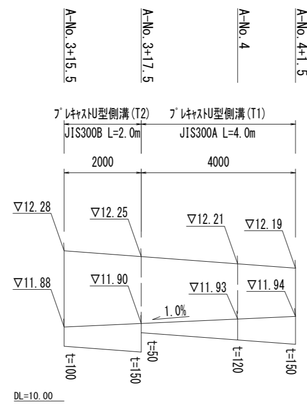
プレキャストU型側溝 (T1) ・ (T2) 展開図 V=1:20 H=1:100
