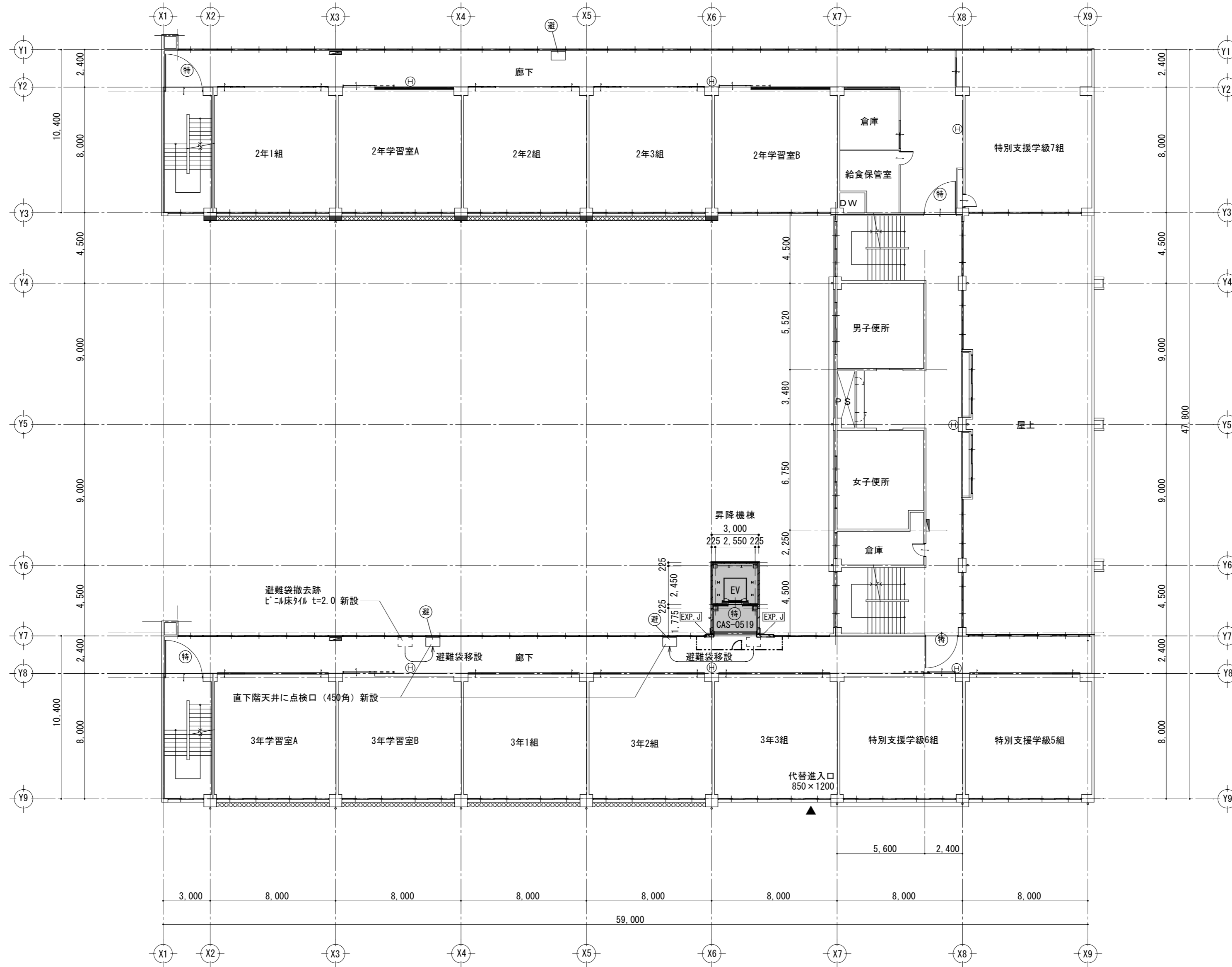
3階平面図兼内部仮設計画図 S=1:200
