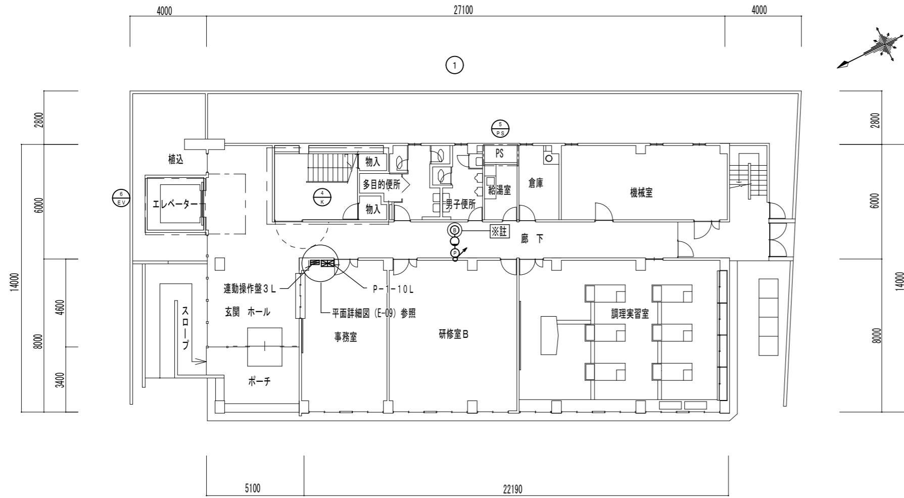
1階自動火災報知設備 平面図 S=1/200
