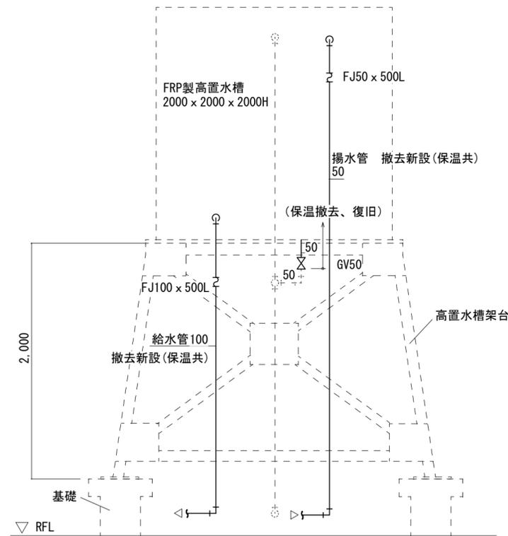
高置水槽架台立面図(南面) 1/30
