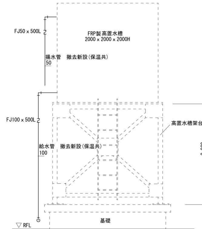
高置水槽架台立面図(東面) 1/30
